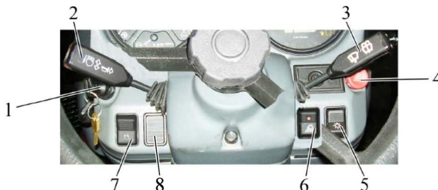
1 – выключатель стартера и приборов; 2 – многофункциональный подрулевой переключатель левый; 3 – многофункциональный подрулевой переключатель правый; 4 – выключатель аварийной световой сигнализации; 5 – центральный переключатель света; 6 – выключатель передних рабочих фар, установленных на кронштейнах передних фонарей; 7 – дистанционный выключатель АКБ; 8 – заглушка.
