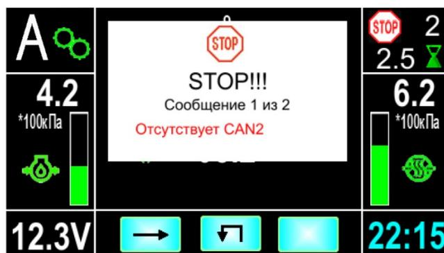
Рисунок 2.23.10 – Пример отображение критической неисправности
